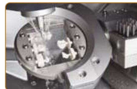
Usinage sous eau intégré
