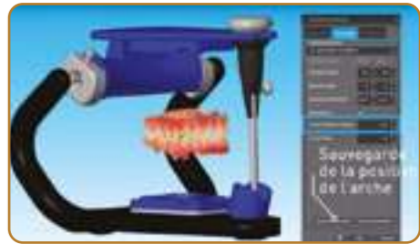
ARTICULATEUR VIRTUEL : Modification de l'occlusion dans l'articulateur virtuel
